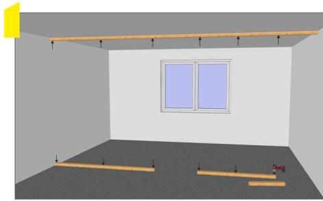
Richte die Decken- und Bodenhölzer lotrecht und parallel zueinander aus und schraube sie fest. Achte dabei auf die Aussparung der Bodenschwelle zur späteren Montage der Tür.
