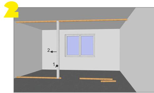
Führe jetzt das Startelement zwischen Decken- und Bodenholz ein.
