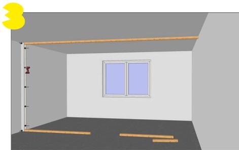
Schiebe das Startelement bis zur Wand und verschraube es.
