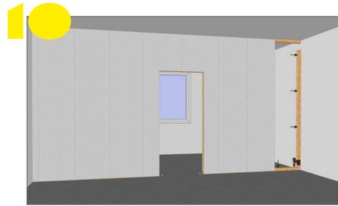
Schieb weitere Wandelemente auf und verschraube sie. Bring dann die Bodenhölzer aus Schritt 1 an.
