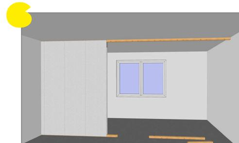
Mach nach dem gleichen Prinzip weiter: Wandelement aufschieben und verschrauben.
