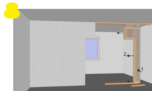
Das zweite Türelement wird vom anderen Wandende aus aufgeschoben und verschraubt.
