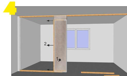
Nimm das erste Wandelement und schieb es auf, bis die Feder in die Nut greift.
